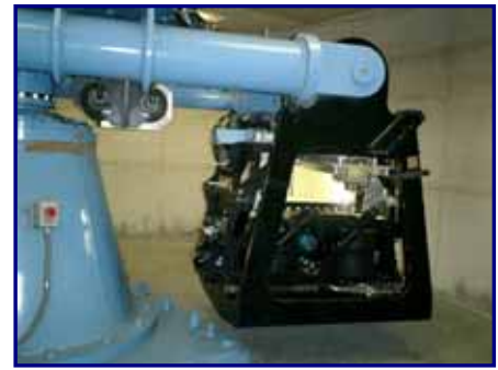
写真-4 遠心振動台実験装置
